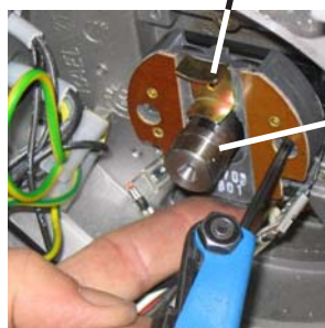
CENTRIFUGAL SWITCH ACTUATOR
