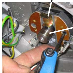
CENTRIFUGAL SWITCH ACTUATOR
